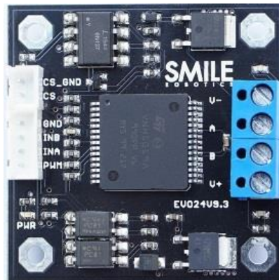
รูปที่ 5.9 บอร์ด EVO24V9.3 H-Bridge DC Motor Drive Model
