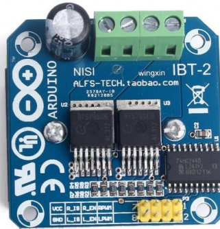
รูปที่ 5.7 บอร์ดไดรฟ์มอเตอร์ DC Model BTS7960
